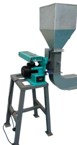
Gambar 5. Prototipe alat pencacat kemasan hasil realisasi di bengkel kerjaB.
